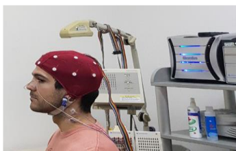
Слика 1 EEG капа и електроде на m. Sternocleidomastoideus
